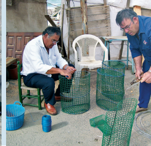
Construyendo nasas con malla de plástico y armazones metálicos
