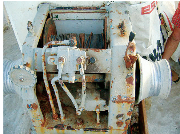
Maquinilla de “almeja”, utilizada para las faenas con rastros. Podemos apreciar el eje central donde va enrollado el cable y los tamborettes (libre en este momento)
