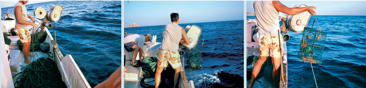
Secuencia de la faena de llevar las nasas: se saca la madre ordenadamente y cuando llega una nasa se coge con la mano y se sube al barco sin pasar por el halador.
