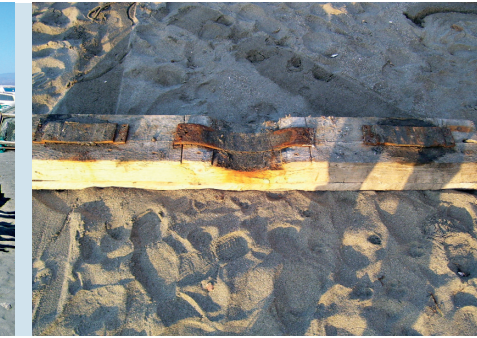
Paral con las planchas para el deslizamiento del barco
