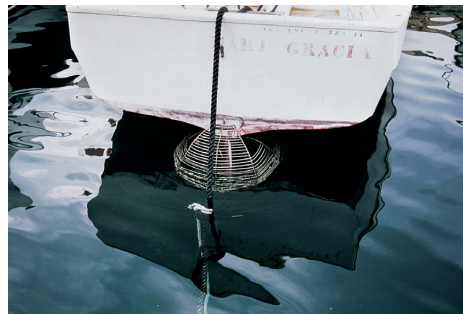
Protección de las hélices de la embarcación para faenar en la moruna
