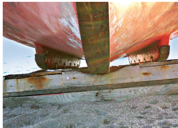
Detalle de la quilla y carenotes apoyado en un paral
