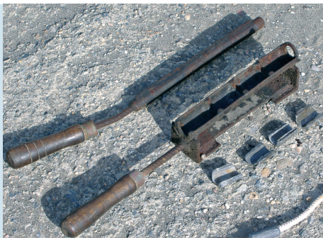
Máquina con plomos ya hechos y enganchados en una tralla
